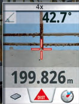
Le viseur numérique permet une visée simple et rapide d'objets éloignés, en plein soleil. Même si le point laser est invisible à l'œil nu, le grand écran couleur le matérialise très clairement. La haute résolution garantit une image très nette. Pour réaliser des mesures de distance d'une précision absolue sur de longues étendues.
