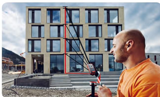
Mesure continue de hauteur avec capteur d'inclinaison
